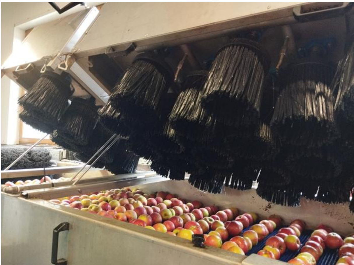
Abbildung 13: Hochgeklappter Deckel mit Bürstköpfen - unten waagerecht verlaufende Bürstrollen, Borsten oben etwa bleistiftlang
