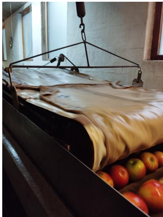
Abbildung 11: Eigens gebaute Bürstmaschine aus den 1980er Jahren mit Gewebeband oben
