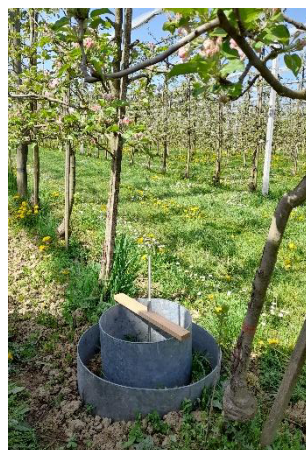
Abbildung 21: Doppelringinfiltrometer im Baumstreifen
