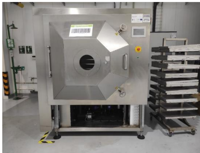
Abb. 4.8. Die Produktions-Gefriertrocknungsanlage bei INTERMAG.
