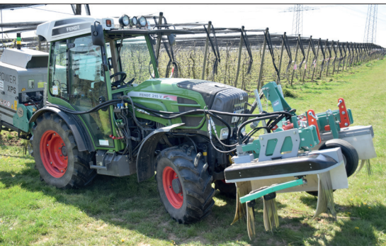
Abb. 1: Elektrophysikalisches Verfahren XPower XPS
