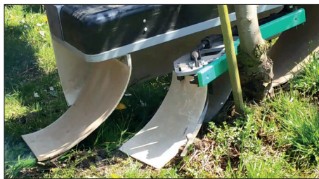
Abb. 6: Kurzfristige Überlagerung der Applikatoren bei der Herumführung um den Stammbereich
