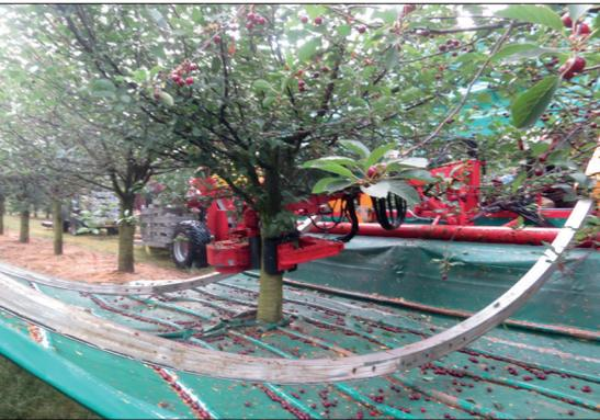
Abb. 8: Ausschubsystem Typ ASR mit Rundbogen (Modell Stier) zum Anbau an Schüttelgerät AES, Tuchgröße 6,0 m x 6,0 m; Foto: Fa. Lipco
