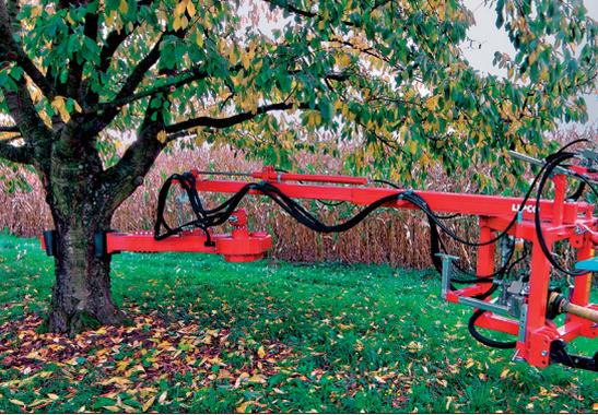
Abb. 7: Schüttelaggregat HSA 10 der Firma Lipco (verwendbar bis 55 cm Stammdurchmesser, mit Teleskop-Aus-schub, mind. 54 PS-Schlepper nötig); Foto: Fa. Lipco
