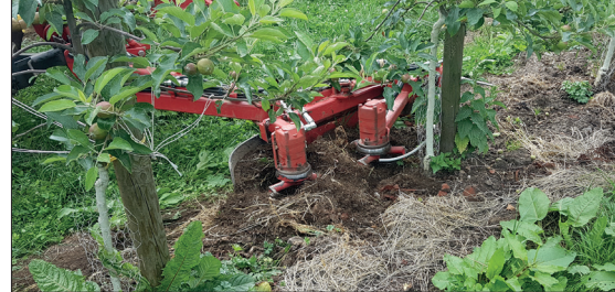
Abb. 2: Krümmerwerkzeuge beim Arbeiten im Baumstreifen
