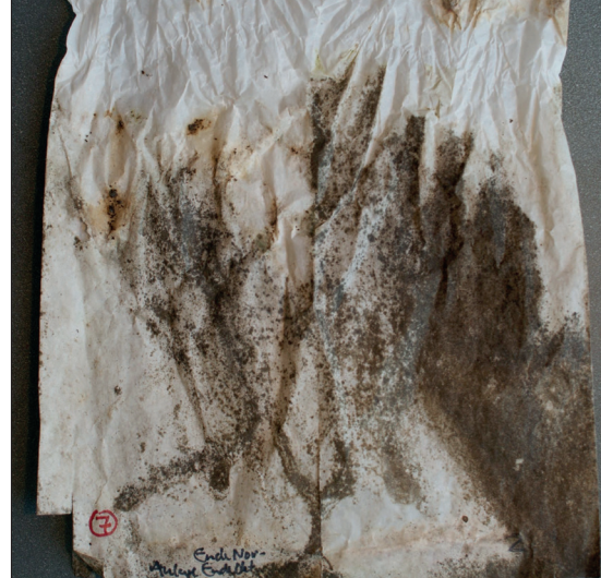
Abb. 4: Wachspapier mit dichter Besiedlung durch P. cerophilus nach elf-monatiger Exposition in der Topaz-Versuchsanlage am KOB Bavendorf.
