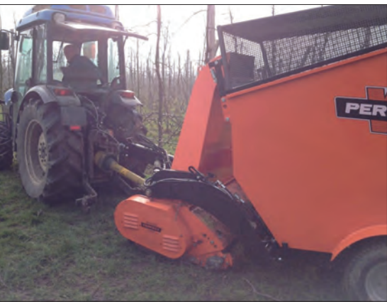
Abb. 4: Falllaub kann teilweise maschinell entfernt werden. Zuerst werden die Blätter aus der Reihe in den Grasstreifen geputzt, wo sie maschinell aufgesaugt werden. Das Falllaub kann jedoch nicht vollständig entfernt werden. Das verbleibende Laub wird von den Regenwürmern abgebaut.
